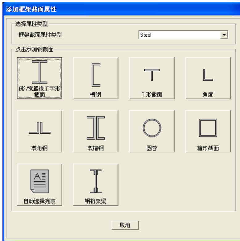
图 9 导入框架截面属性对话框
