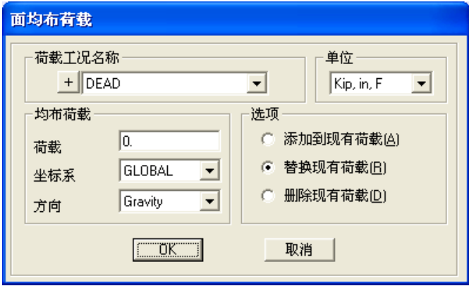
图 29 面均布荷载对话框
