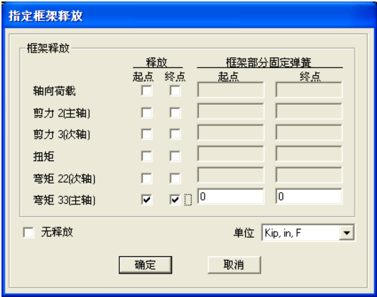
图 19 指定框架释放对话框
