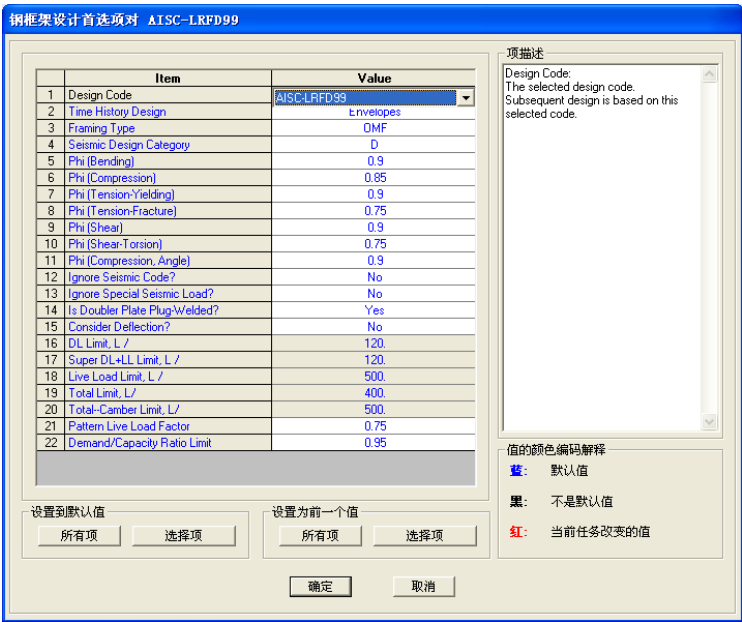
图 40 钢框架设计首选项对话框
